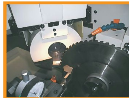
● 先端傾き45° 研磨姿勢 先端逃げ角 0° ~ +25° 先端傾き角 ~±45°
